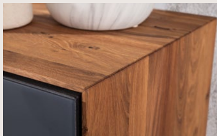
Holzverbindung Korpusseiten/Deckelplatte/ Sockelplatte auf Gehrung (Sicherung durch Clamex-P-Verbinder)
